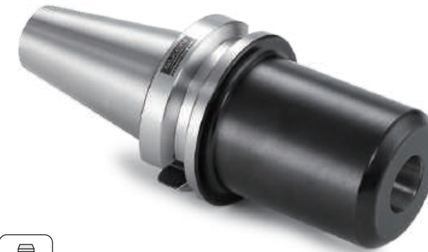
不分孔徑皆為二只鎖緊螺絲用于夾持具有側固平面的刀具
